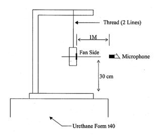
1 METER FROM MICROPHONE TO FAN INTAKE
