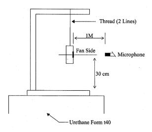
1 METER FROM MICROPHONE TO FAN INTAKE
