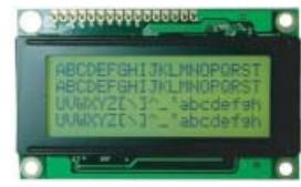
Znakové LCD displeje s počtom znakov 4x20. Modely s príponou BNHEH majú biele podsvietenie (negative) a modrú polarizačnú fóliu, model BC 2004A FNHEH je čierne - biely (negatívny). Ostatné modely majú žlté - zelené LED podsvietenie. Sú určené pre pracovné teploty v rozmedzí -20°C až +70°C.
