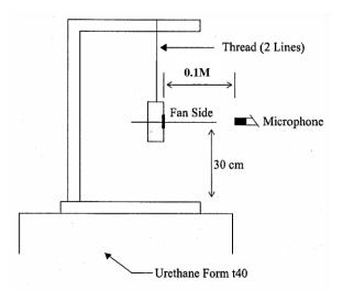
0.1 METER FROM MICROPHONE TO FAN INTAKE
