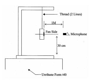
1 METER FROM MICROPHONE TO FAN INTAKE
