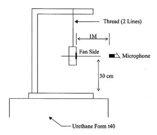
1 METER FROM MICROPHONE TO FAN INTAKE
