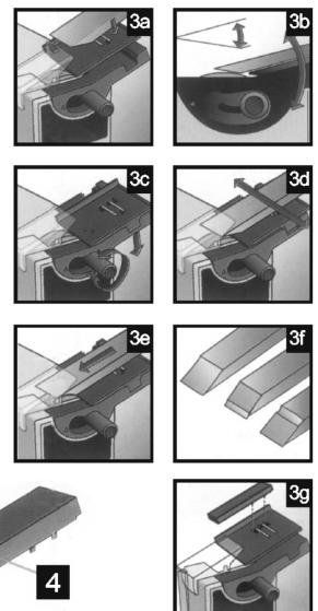
• Plaats het gereedschap (bijv. een steekbeitel) zo, dat de magneet (2) het werkstuk vasthoudt (3a). Voor smalle gereedschappen kan een kleiner kunststof inzetstuk (4) aan de zijkant worden opgestoken, zodat de magneet het gereedschap kan vasthouden (3g).
