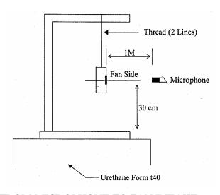
1 METER FROM MICROPHONE TO FAN INTAKE
