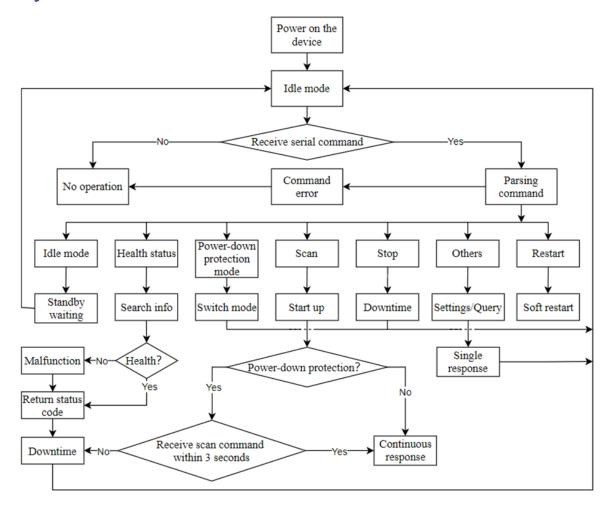
FIG 1 YDLIDAR G4 WORKFLOW
