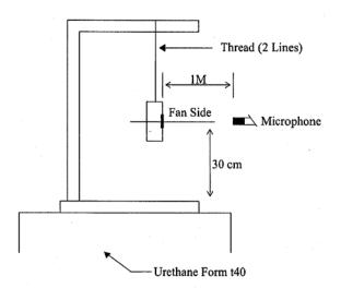
1 METER FROM MICROPHONE TO FAN INTAKE
