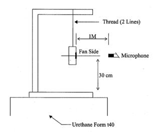
1 METER FROM MICROPHONE TO FAN INTAKE
