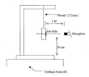
1 METER FROM MICROPHONE TO FAN INTAKE
