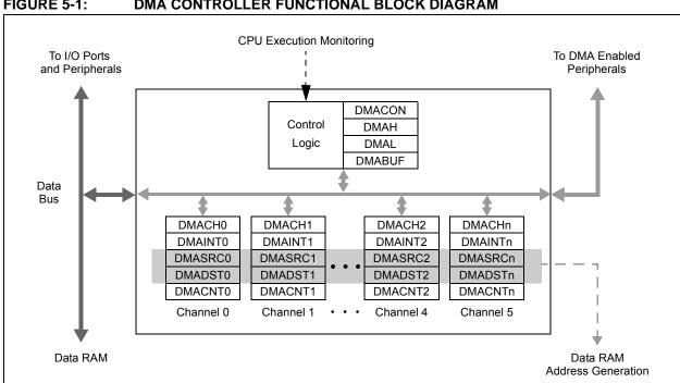
FIGURE 5-1: DMA CONTROLLER FUNCTIONAL BLOCK DIAGRAM
