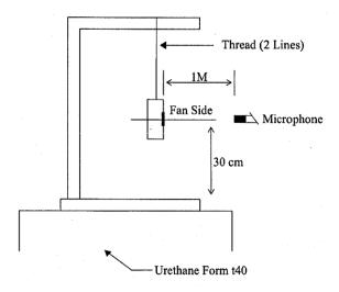
1 METER FROM MICROPHONE TO FAN INTAKE
