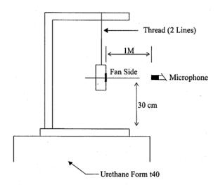
1 METER FROM MICROPHONE TO FAN INTAKE
