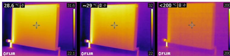
**Abbildung 16.4** Bilder von einer FLIR T440 mit Temperaturbereichen von  $-20$  bis  $+120$  °C, (links),  $0$  bis  $+650$  °C (Mitte) und  $+250$  bis  $+1200$  °C (rechts). Alle anderen Einstellungen sind unverändert.
