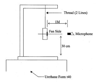
1 METER FROM MICROPHONE TO FAN INTAKE
