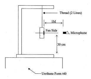
1 METER FROM MICROPHONE TO FAN INTAKE
