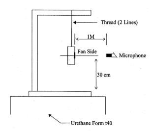
1 METER FROM MICROPHONE TO FAN INTAKE
