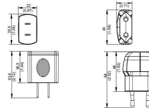
Alle Abmessungen in Millimeter (Inch), Abweichung ± 0,5 (0,02)
