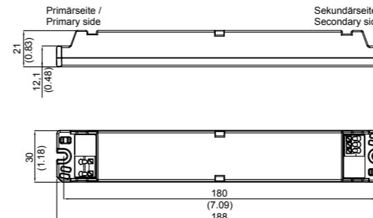
Alle Abmessungen in Millimeter (Inch), Abweichung ± 0,5 (0,02)
