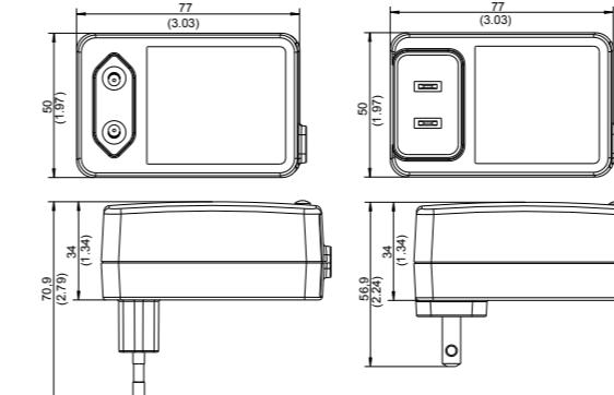
Alle Abmessungen in Millimeter (Inch), Abweichung ± 0.5 (0.02)
