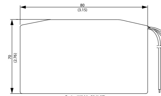
Alle Abmessungen in Millimeter (Inch), Abweichung ± 0,5 (0,02)
