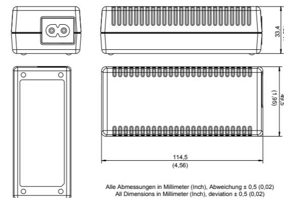
Alle Abmessungen in Millimeter (Inch), Abweichung ± 0.5 (0.02)
