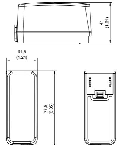
Alle Abmessungen in Millimeter (Inch), Abweichung ± 0,5 (0,02)
