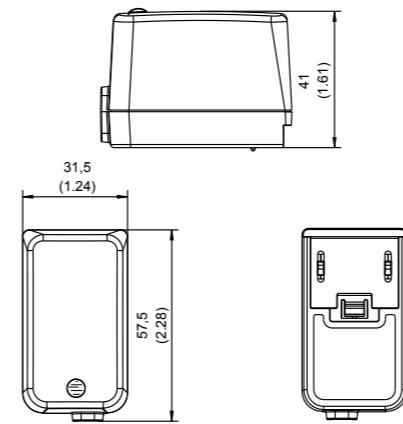
Alle Abmessungen in Millimeter (Inch), Abweichung ± 0,5 (0,02)
