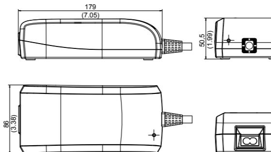
Alle Abmessungen in Millimeter (Inch), Abweichung ± 0.5 (0.02)
