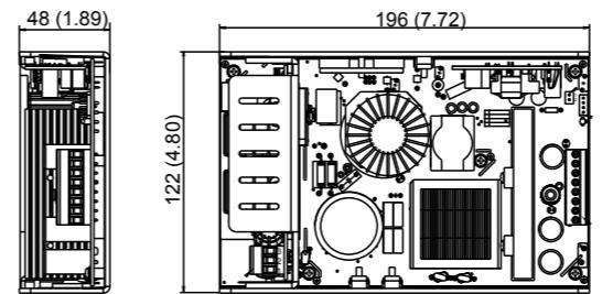
Alle Abmessungen in Millimeter (Inch), Abweichung ± 0.5 (0.02)
