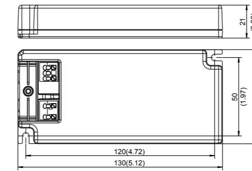
Alle Abmessungen in Millimeter (Inch), Abweichung ± 0,5 (0,02)
