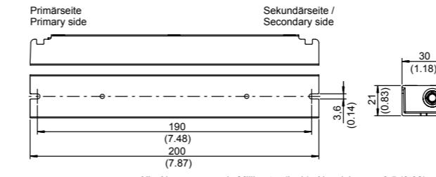
Alle Abmessungen in Millimeter (Inch), Abweichung ± 0,5 (0,02)
