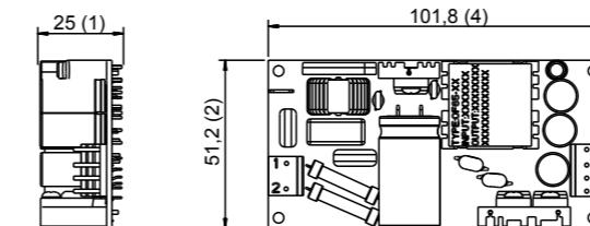
Alle Abmessungen in Millimeter (Inch), Abweichung ± 0.5 (0.02)
