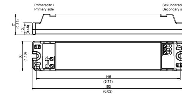
Alle Abmessungen in Millimeter (Inch), Abweichung ± 0,5 (0,02)
