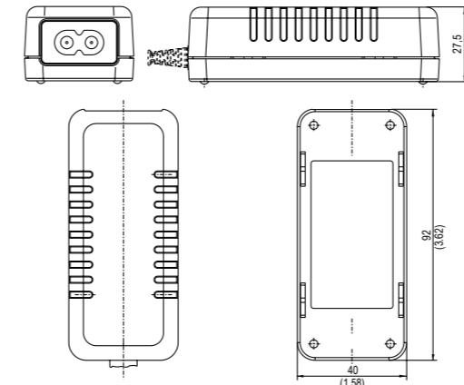
Alle Abmessungen in Millimeter (Inch), Abweichung ± 0.5 (0.02)
