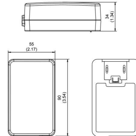
Alle Abmessungen in Millimeter (Inch), Abweichung ± 0,5 (0,02)
