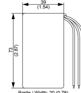
Alle Abmessungen in Millimeter (Inch), Abweichung ± 0,5 (0,02)
