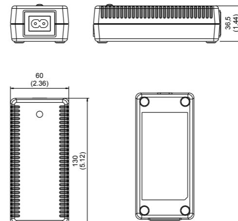
Alle Abmessungen in Millimeter (Inch), Abweichung ± 0,5 (0,02)
