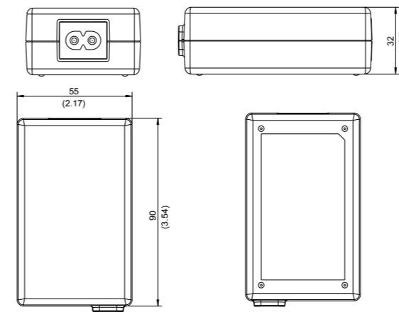
Alle Abmessungen in Millimeter (Inch), Abweichung ± 0.5 (0.02)
