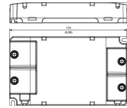
Alle Abmessungen in Millimeter (Inch), Abweichung ± 0,5 (0,02)
