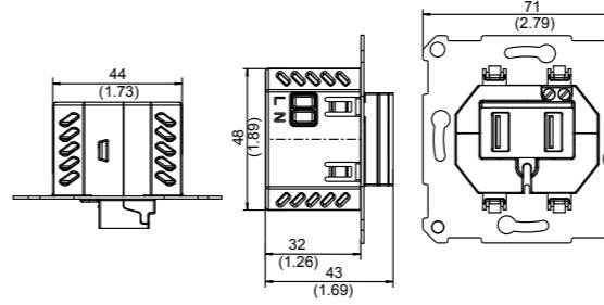
Alle Abmessungen in Millimeter (Inch), Abweichung ± 0,5 (0,02)
