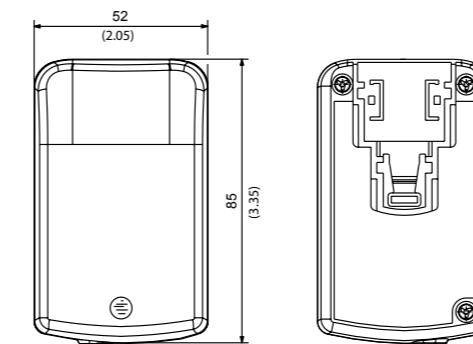
Alle Abmessungen in Millimeter (Inch), Abweichung  $\pm 0.5$  (0.02)
