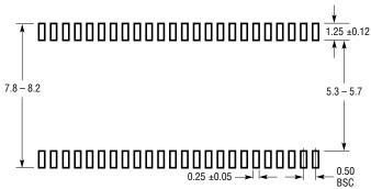
RECOMMENDED SOLDER PAD LAYOUT APPLY SOLDER MASK TO AREAS THAT ARE NOT SOLDERED
