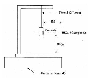
1 METER FROM MICROPHONE TO FAN INTAKE
