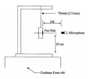
1 METER FROM MICROPHONE TO FAN INTAKE
