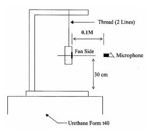
0.1 METER FROM MICROPHONE TO FAN INTAKE
