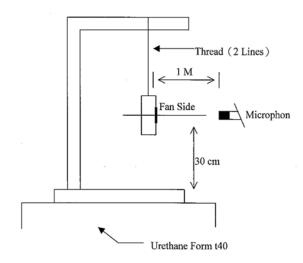
1 METER FROM MICROPHONE TO FAN INTAKE
