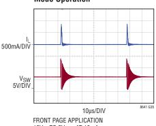
12V<sub>IN</sub> TO 5V<sub>OUT</sub> AT 10mA  $V_{SYNC} = 0V$
