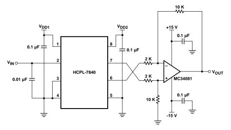
$\textbf{V}_{\textbf{IN}}$  IMPEDANCE LESS THAN 10  $\Omega.$
