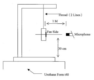
1 METER FROM MICROPHONE TO FAN INTAKE
