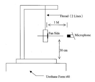
1 METER FROM MICROPHONE TO FAN INTAKE
