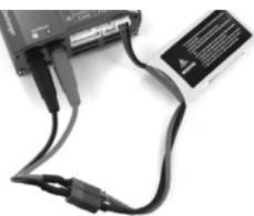
Als u de verbinding niet volgens dit schema maakt, zal de lader schade oplopen. Om kortsluiting tussen de banaanstekkers te voorkomen, verbind de laadkabels eerst met de lader en dan pas met de accu. Draai de volgorde om om te ontkoppelen.
