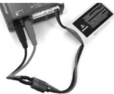
Si le branchement n'est pas effectué comme montré sur ce diagramme, ce chargeur sera endommagé. Pour éviter un court-circuit entre les cordons de charge, veuillez toujours connecter le câble de charge d'abord au chargeur et ensuite connecter l'accumulateur. Inversez l'ordre de procédure lorsque vous débranchez.
