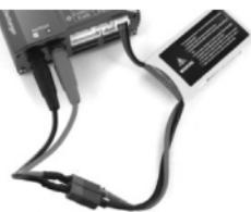
Bei Nichteinhaltung der in dieser Abbildung dargestellten Verbindung wird das Ladegerät beschädigt. Um Kurzschlüsse zwischen den Ladekabeln zu vermeiden, schließen Sie das Ladekabel immer zuerst an das Ladegerät und erst dann an den Akku an. Folgen Sie beim Trennen des Akkus der umgekehrten Reihenfolge.
