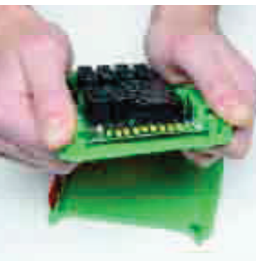
Estrazione della scheda elettronica. Removing the pcb.
