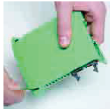
Agire con cura per evitare la rottura dei ganci. Handle with care to avoid hook breakings.
