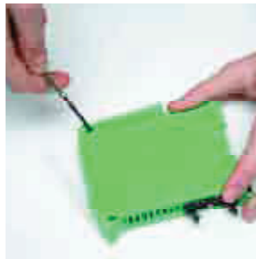
Sgancio del coperchio dalla base. Unhooking the cover from the base.
