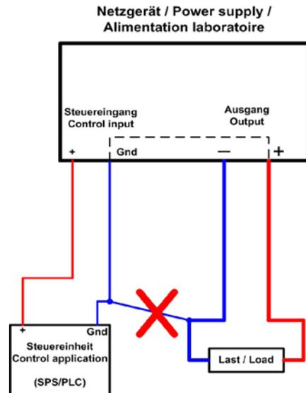
Um die Spannung an der Last zu messen, wird „Remote sense“ verdrahtet und aktiviert. Der Meßausgang UMON, für den Istwert der Spannung, repräsentiert dann den Spannungswert an der Last und kann mit der Steuerapplikation erfaßt und gemessen werden. Dies verhindert, daß Laststrom über eine der Steuer- bzw. Lastleitungen fließt.
