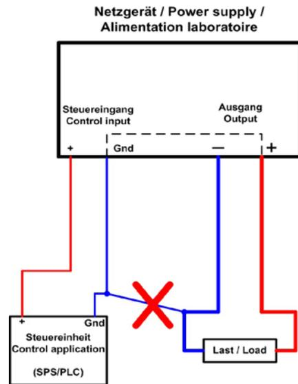
Pour mesurer la tension au niveau du consommateur connecté, le dispositif de compensation de chute de tension « Remote Sense » est câblé et activé. La valeur mesurée à la sortie du moniteur de tension UMON qui correspond à la valeur réelle de la tension représente alors la valeur de tension au niveau de l'équipement connecté et peut être saisie et mesurée par l'application de commande. Ceci empêche le courant de charge de passer par des conducteurs de commande ou de puissance.
