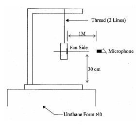
1 METER FROM MICROPHONE TO FAN INTAKE
