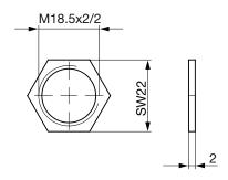
3-129-865 Max. torque 1.2 Nm 3-129-864 Max. torque 2.4 Nm
