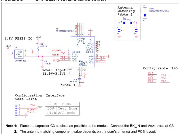
FIGURE 2-6: BM71BLE01FC2 REFERENCE CIRCUIT
