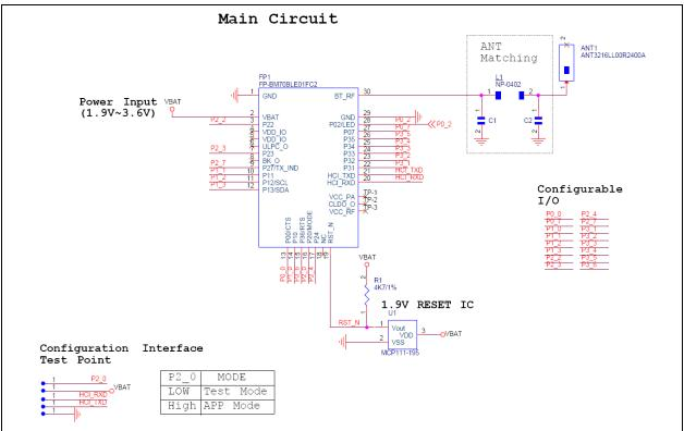
FIGURE 2-4: BM70BLE01FC2 REFERENCE CIRCUIT
