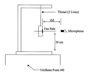
1 METER FROM MICROPHONE TO FAN INTAKE
