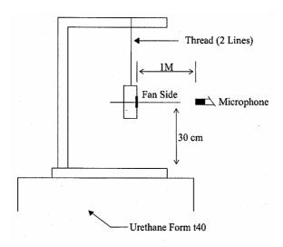
1 METER FROM MICROPHONE TO FAN INTAKE
