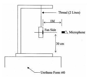
1 METER FROM MICROPHONE TO FAN INTAKE
