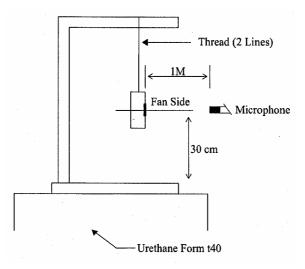
1 METER FROM MICROPHONE TO FAN INTAKE
