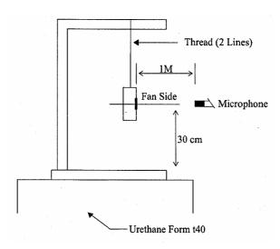
1 METER FROM MICROPHONE TO FAN INTAKE
