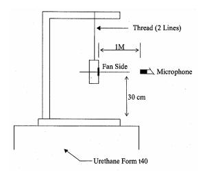
1 METER FROM MICROPHONE TO FAN INTAKE
