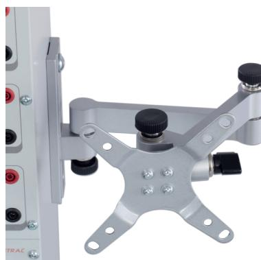
Monitor počítače, nebo měřící přístroj může být připevněn na držáku, zajistující plynulé nastavení polohy dle momentální potřeby.
