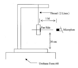
1 METER FROM MICROPHONE TO FAN INTAKE
