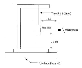
1 METER FROM MICROPHONE TO FAN INTAKE
